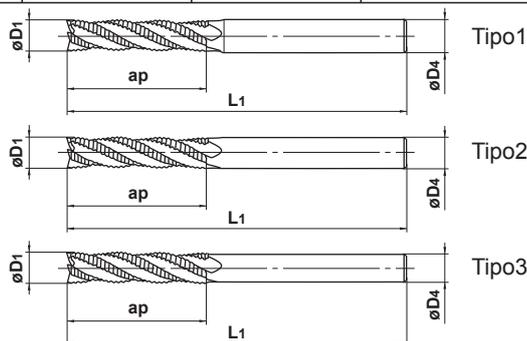
● Fresa integral de desbaste con sustrato de pulvimetalurgia de alto grado HSS con recubrimiento Violet para una larga vida de la herramienta.
